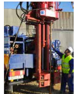
Sonda TP-50/400 MP sobre camión IVECO 4 x 4
