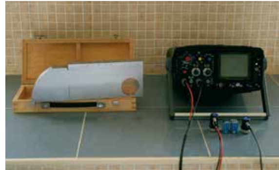
Equipo de inspección de soldaduras por ultrasonidos
