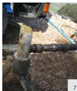
Testigo obtenido con corona de diamante
